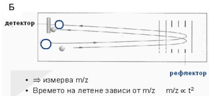
Фиг. 7. А) MALDI-TOF в линеен и Б) рефлектoren режим на измерване.
