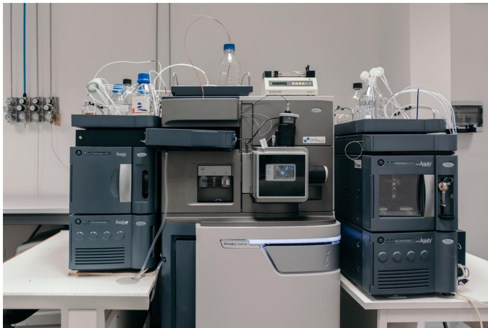
Фиг. 4 Апарат Synapt G2-Si UPLC-q/IM/TOF (Waters) – за реализиране на TWIM-MS. Копирано от ATeN Center (Италия).
